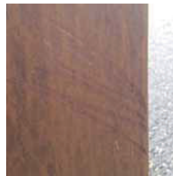
Kratzer in der jungen Oberfläche, z.B. durch Transport, Montage etc
