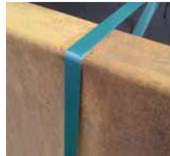
Abdrücke durch Spanngurte etc. beim Transport oder durch Kontakt bei der Lagerung
