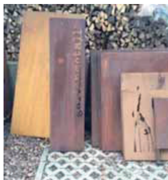
Beispiel für berosteten Cortenstahl nach 0 bis 12 Monaten
